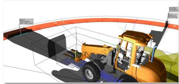
**EMM-Check 4** ist mit den zur Zeit acht verschiedenen Standards das Werkzeug für Sichtfelduntersuchungen am virtuellen Nutzfahrzeug für Hersteller von
